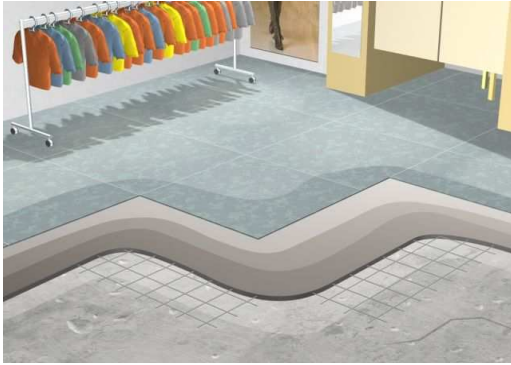
Bild 1: Systemskizze Designfloor mit Scheinfugenoptik
